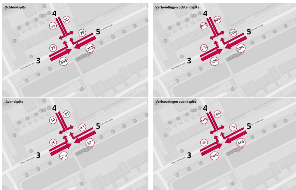
Figuur 3.2: Resultaten kruispuntstromen slangtellingen en verhoudingen per tak
