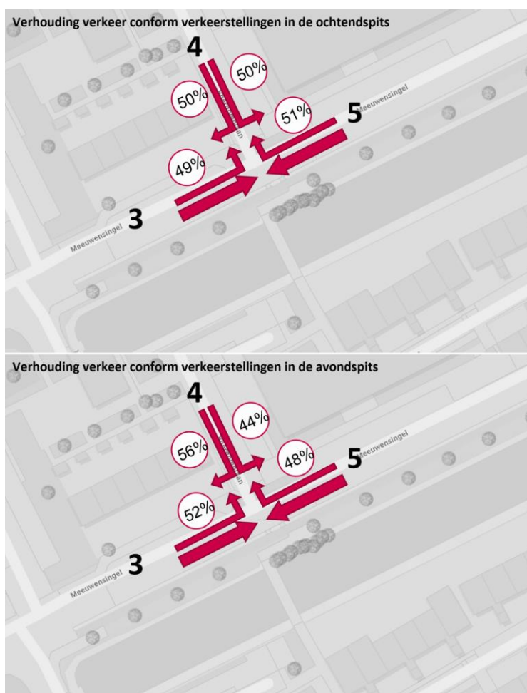
Figuur 3.1: Kruispuntstromen conform handmatige verkeerstellingen en schouw
