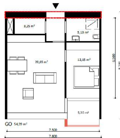
Variant 1 berging en badkamer aan geluidsbelaste gevel
