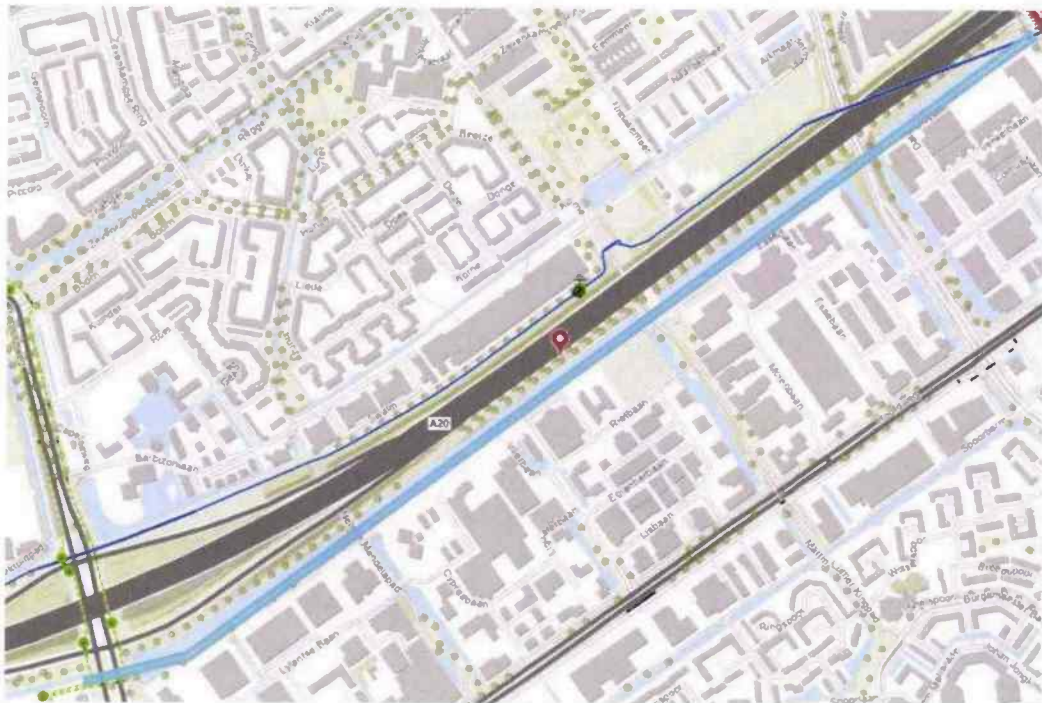
Afbeelding 1: Ondergrondse hoogspanningsverbinding (donkerblauwe lijn) t.o.v. het voorliggende plan (lichtblauwe gebied)
