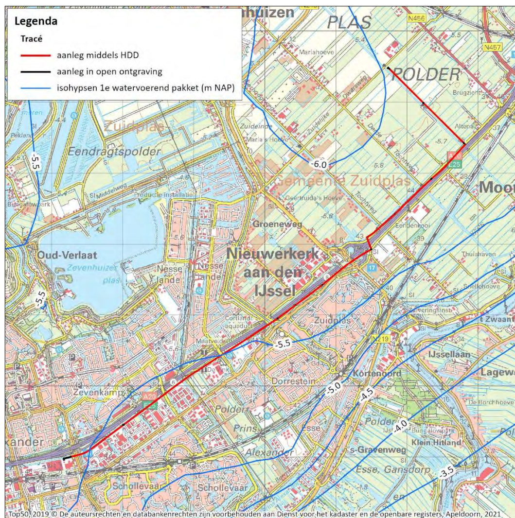
Figuur 2.4: Isohypsen eerste watervoerend pakket op 14-01-2012 met stijghoogte in meters t.o.v. NAP
