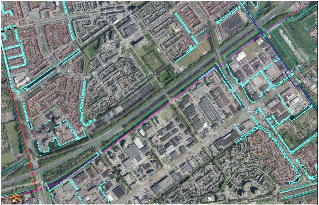
Afbeelding 3a. Foto met bestaande (donkerblauw en rood) en toekomstige gastransportleidingen (paars gestippeld) en het schema (oranje) (bron: www.velin.nl )
