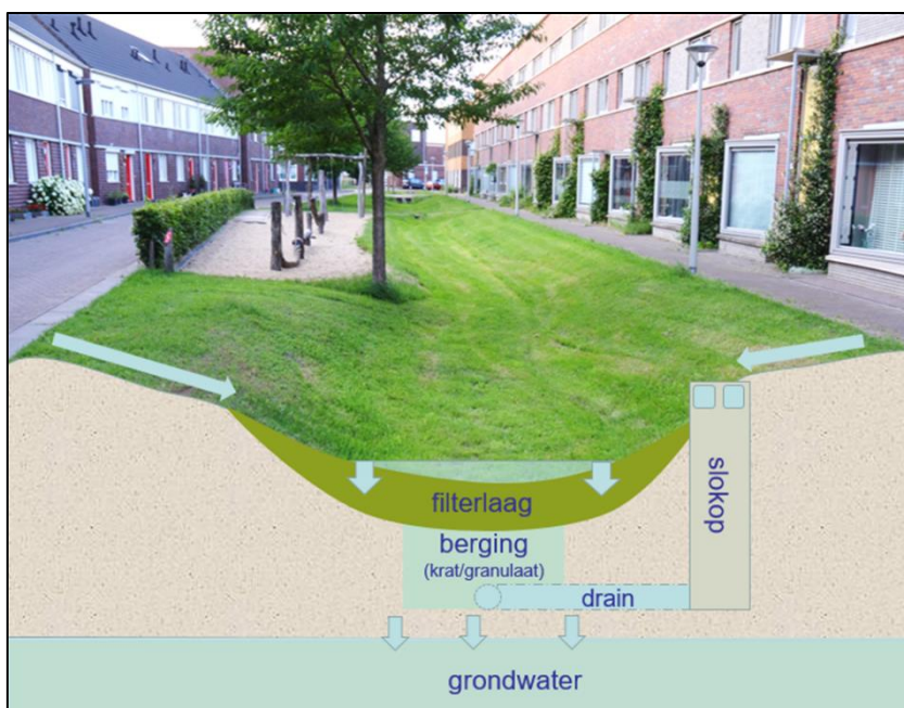
Figuur 17: Dwarsdoorsnede van een wadi. Bron: Kennisportaal Klimaatadaptatie.
