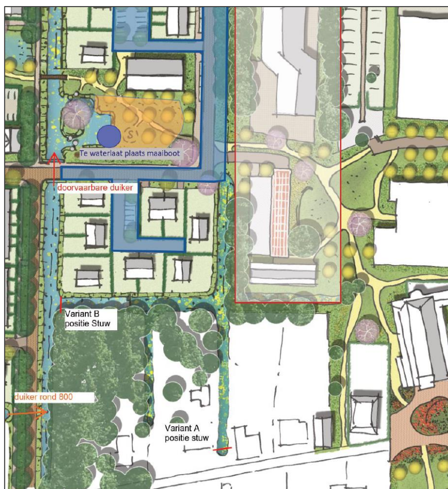
Afbeelding 3.3: mogelijke varianten voor plaatsen stuw aan zuidkant
