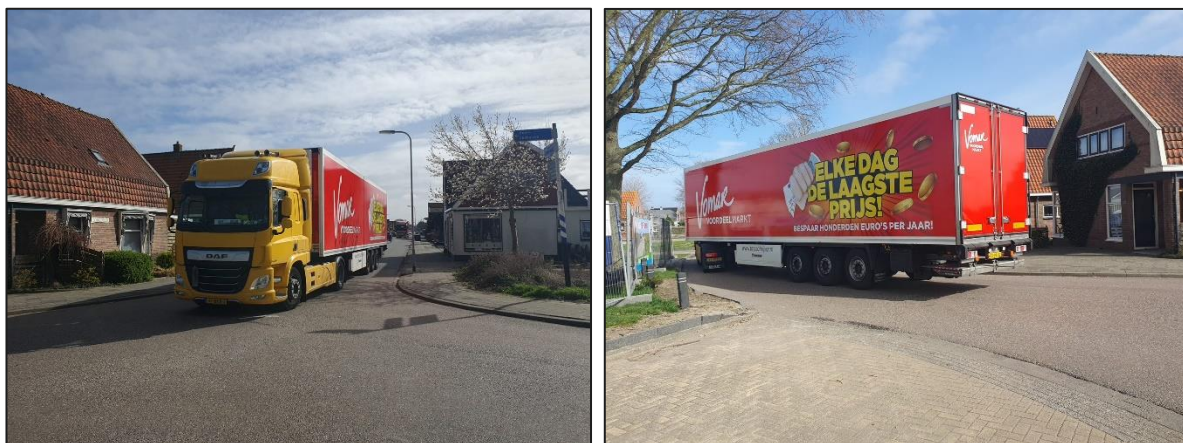
Figuur 4.1: Draaicirkel vrachtwagen in de bocht tussen de Twijver en de Westerkerkweg (bron: Goudappel)
