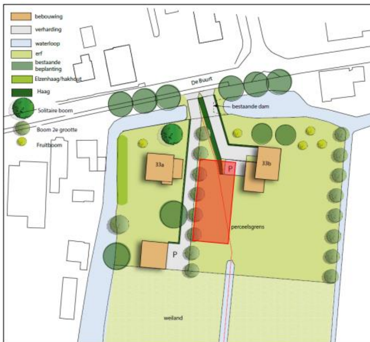
Afb 4: Situatie. Rode vlak is bij benadering de ligging van de te slopen schuur
