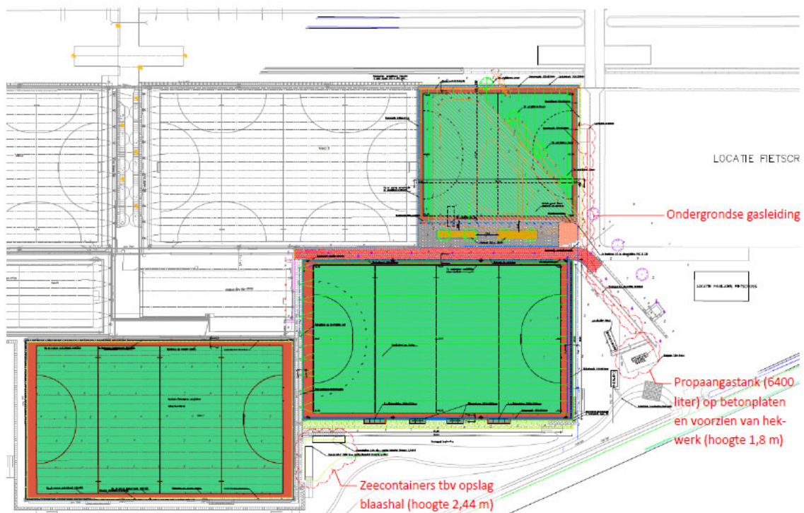
Figuur 3.4 Beoogde locaties plaatsing zeecontainers en propaangastank
