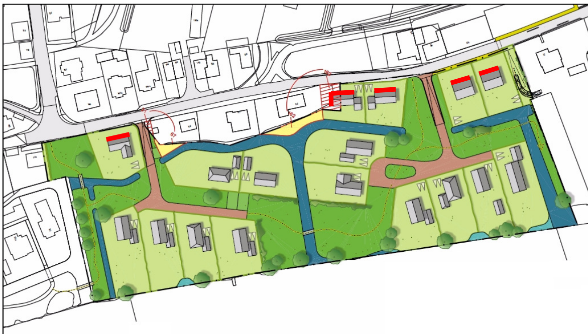
Figuur 4.1: Gevels met een normoverschrijding t.g.v. de Noldijk
