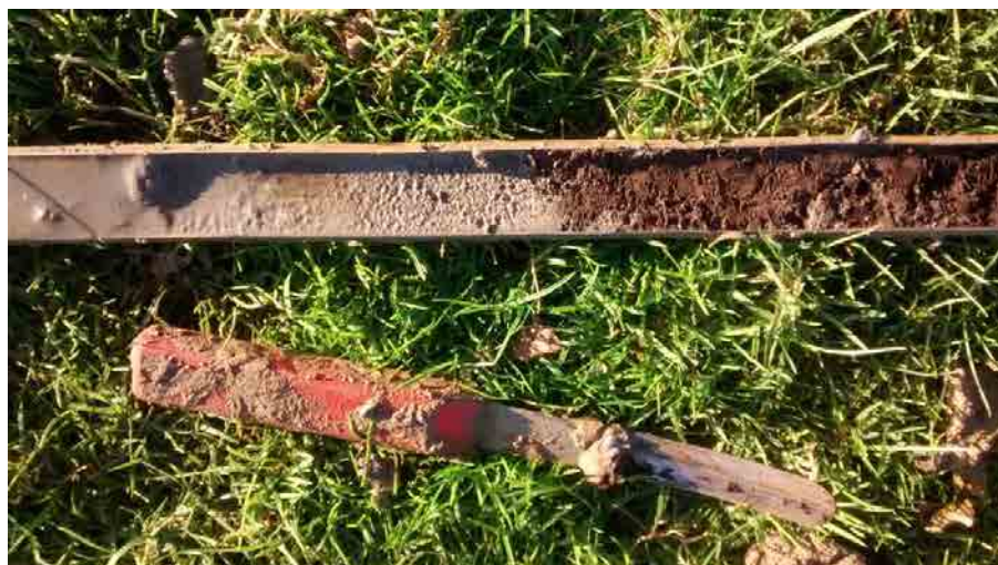
Afbeelding 5. Erosieve overgang van geulafzettingen – zand naar veen (boring 8)
