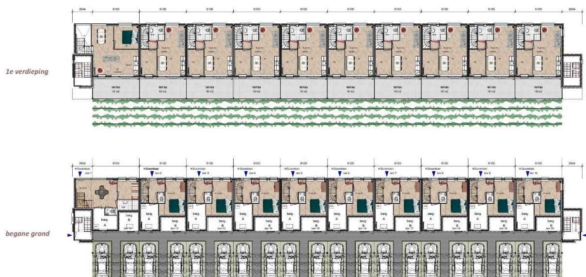
Afbeelding 2.5: Plattegronden benedenwoningen (bron: De Roon Architecten, 12 september 2022).
