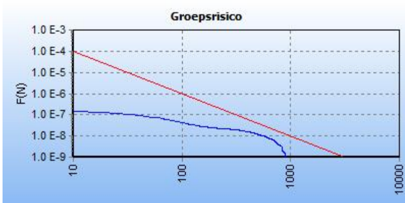
5.2 Figuur 5.2 FN curve voor 7928_leiding-A-555-deel-1 van N.V. Nederlandse Gasunie voor de kilometer tussen stationing 0.00 en stationing 0.00
