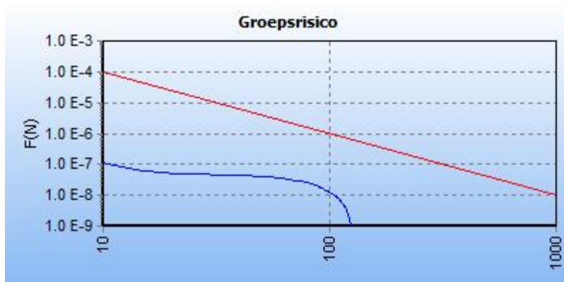
5.4 Figuur 5.4 FN curve voor 7928_leiding-A-559-deel-1 van N.V. Nederlandse Gasunie voor de kilometer tussen stationing 270.00 en stationing 1270.00
