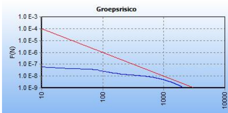
5.4 Figuur 5.4 FN curve voor 7928_leiding-A-559-deel-1 van N.V. Nederlandse Gasunie voor de kilometer tussen stationing 270.00 en stationing 1270.00
