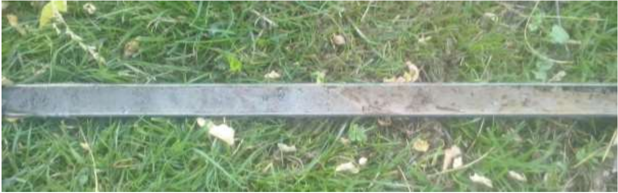
Figuur 4: Foto van de zwak humeuze klei (rechts) op het door kleilaagjes onderbroken zand (links), zoals deze op ruim een meter beneden het maaiveld in de boringen is aangetroffen.
