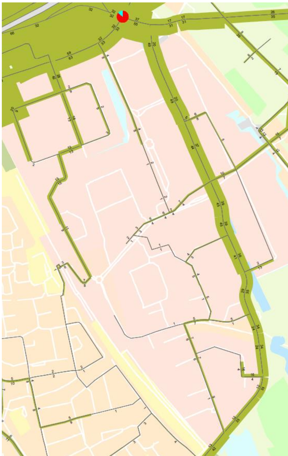
Figuur 19 Fase 1 verhouding intensiteit capaciteit voor de ochtendspits, waarbij een cirkeldiagram aangeeft dat de kruising overbelast is
