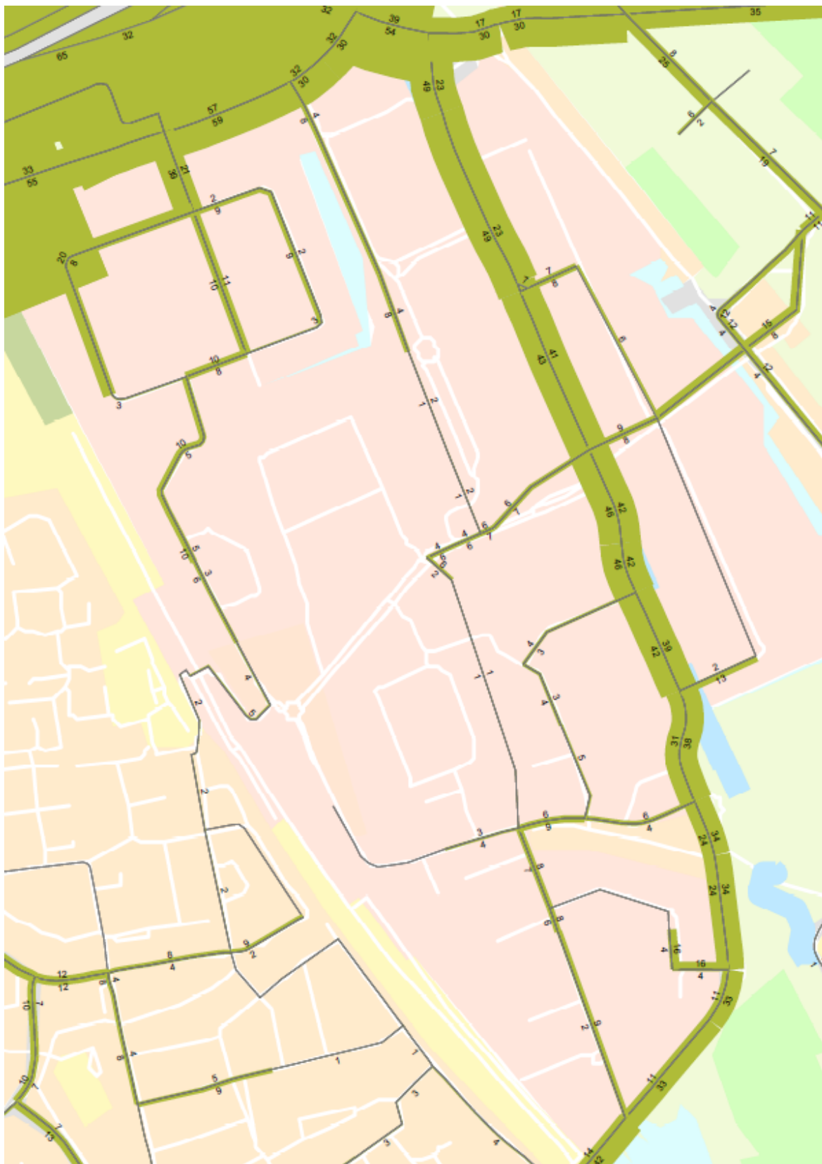
Figuur 26 Fase 2 verhouding intensiteit capaciteit voor de ochtendspits, hier zijn geen overbelaste kruisingen aanwezig
