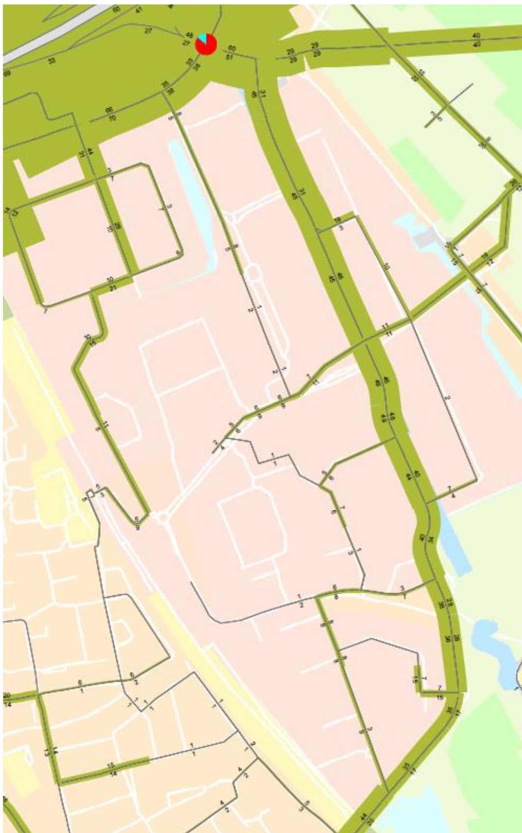
Figuur 20 Fase 1 verhouding intensiteit capaciteit voor de avondspits, waarbij een cirkeldiagram aangeeft dat de kruising overbelast is
