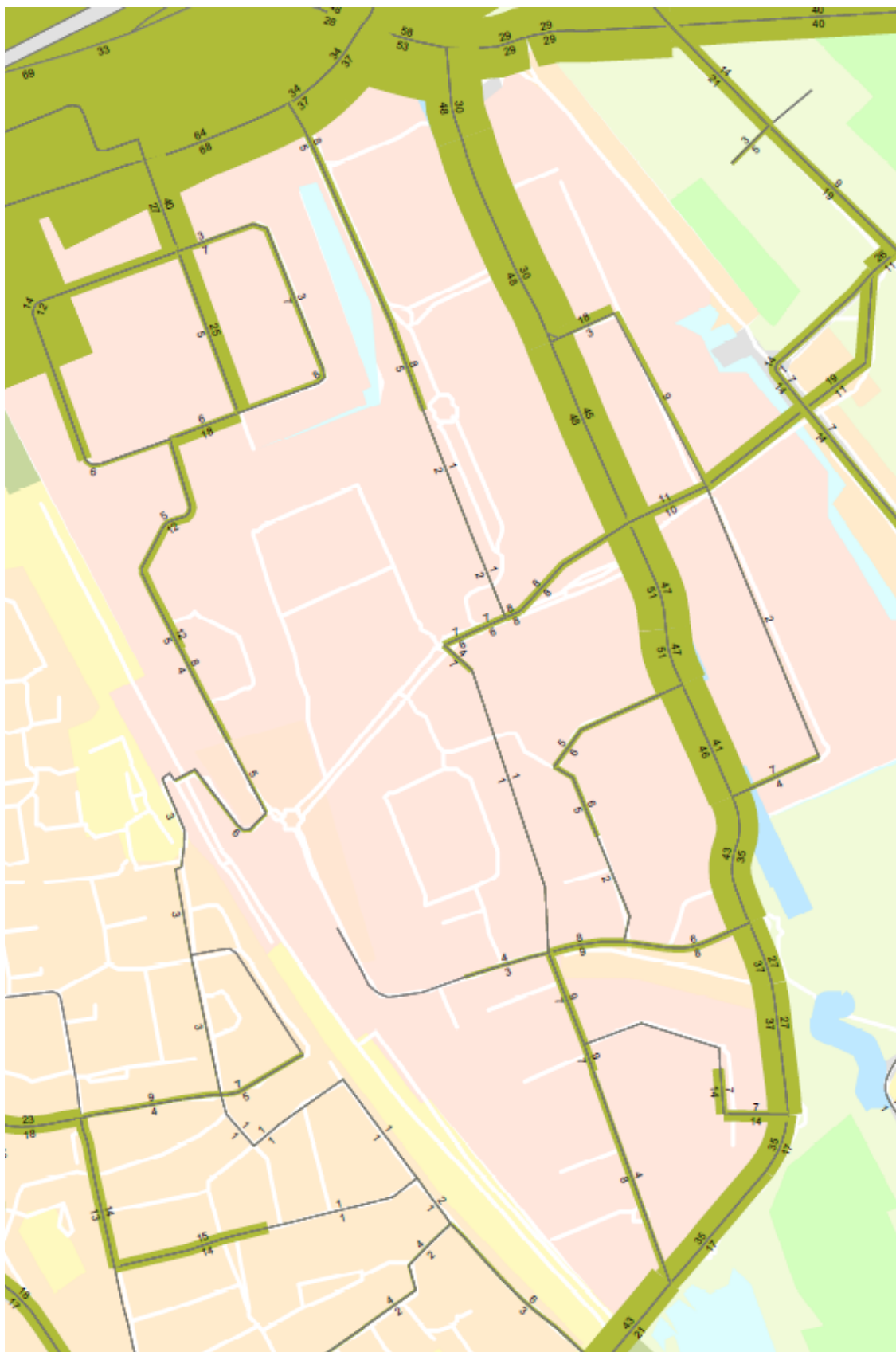
Figuur 27 Fase 2 verhouding intensiteit capaciteit voor de avondspits, hier zijn geen overbelaste kruisingen aanwezig
