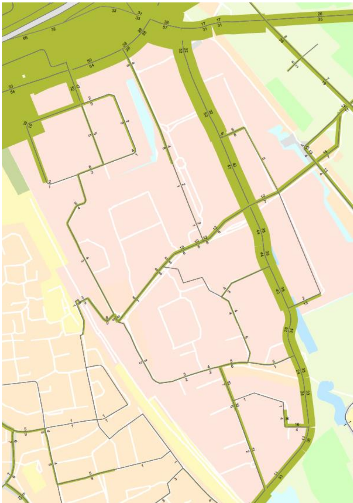
Figuur 12 Autonoom verhouding intensiteit capaciteit voor de ochtendspits, hier zijn geen overbelaste kruisingen aanwezig
