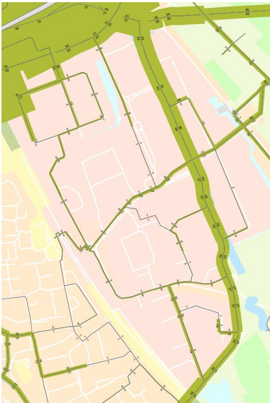
Figuur 13 Autonomo verhouding intensiteit capaciteit voor de avondspits, hier zijn geen overbelaste kruisingen aanwezig
