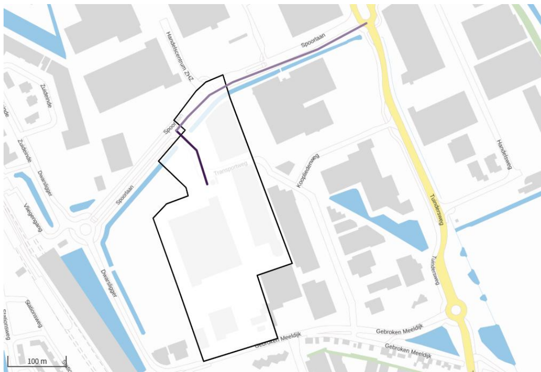
Figuur 3-3: Verkeersafwikkeling bouwverkeer (de vlakbronnen zijn voor de mobiele werktuigen en de koude start van het bouwverkeer, de lijnbronnen zijn voor het bouwverkeer). Bron: AERIUS.
