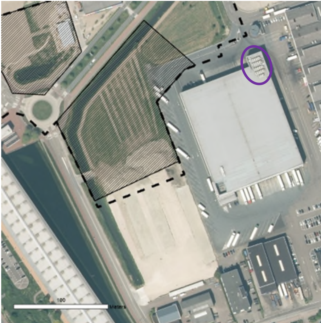
Figuur 3-4: De ligging van de koelers op het dak van bedrijf 1. Bron luchtfoto: PDOK.
