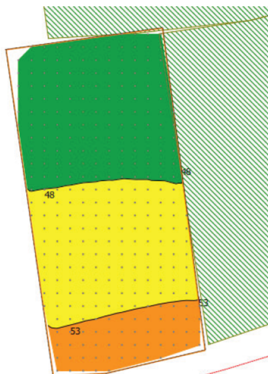
Figuur 5.3: Geluidbelasting t.g.v. de Westeinde op 4,5 meter hoogte incl. 5 dB aftrek ex art. 110g Wgh
