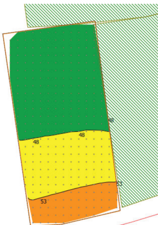
Figuur 5.2: Geluidbelasting t.g.v. de Westeinde op 1,5 meter hoogte incl. 5 dB aftrek ex art. 110g Wgh
