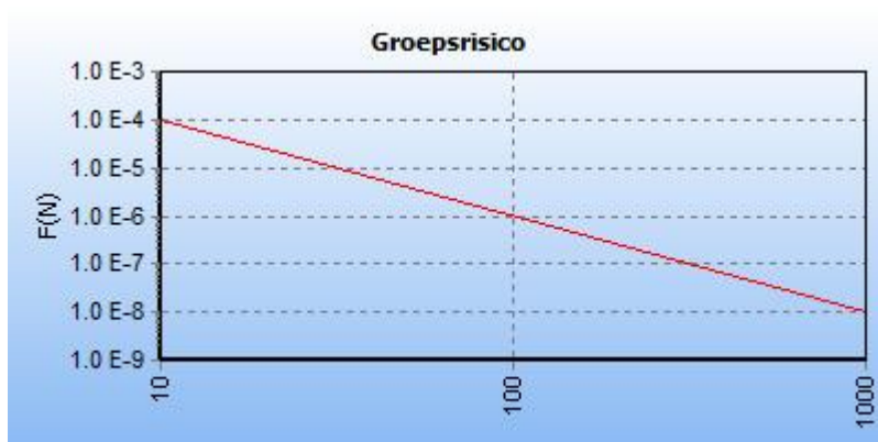
5.5 Figuur 5.5 FN curve voor 4968_leiding-A-554-deel-1 van N.V. Nederlandse Gasunie voor de kilometer tussen stationing 630.00 en stationing 1630.00
