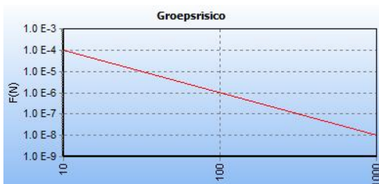
Figuur 2.8: fN-curve buisleiding W-515-deel-1, na planrealisatie
