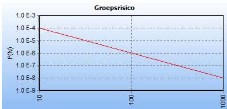
Figuur 2.6: fN-curve buisleiding A-803-deel-1, voor planrealisatie
