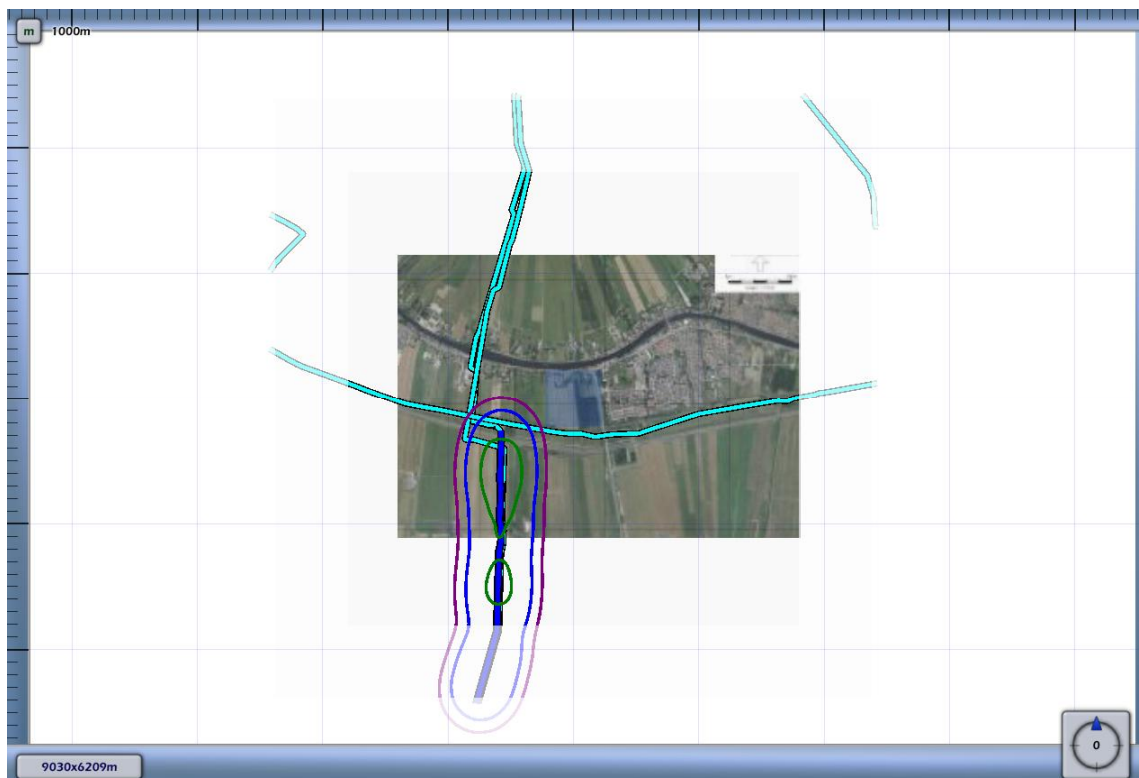
3.3 Figuur 3.3 Plaatsgebonden risico voor 4968_leiding-A-518-deel-1 van N.V. Nederlandse Gasunie
