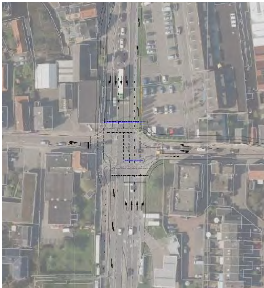
Figuur 39: Indicatie voor het ruimtebeslag van de benodigde opstelstroken voor een goede verkeersafwikkeling in de Alphense variant op het kruispunt N209 - Dorpsstraat.
