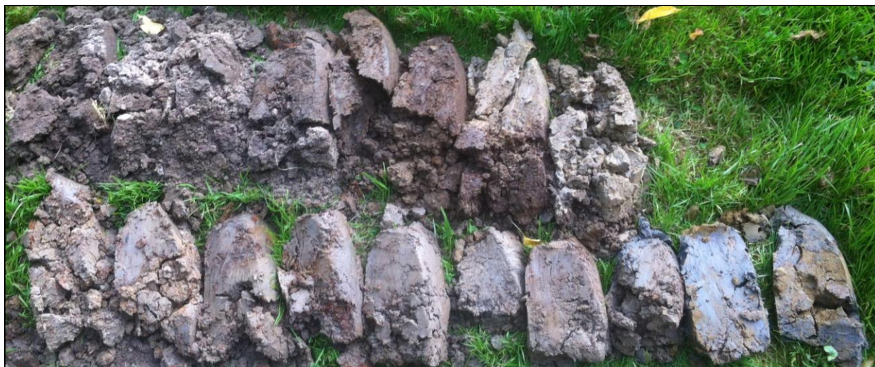
Figuur 6: boorprofiel van boring 3
