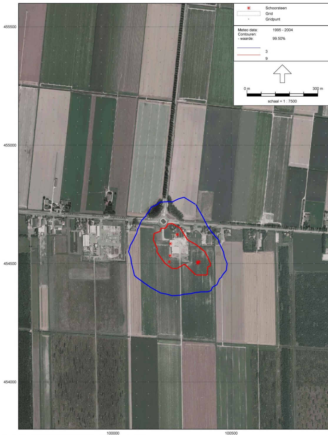
Figuur d Geurcontouren van 3 en 9 ou E /m 3 als 99,5-percentielwaarde als gevolg van Firma ████████ te Benthuizen
