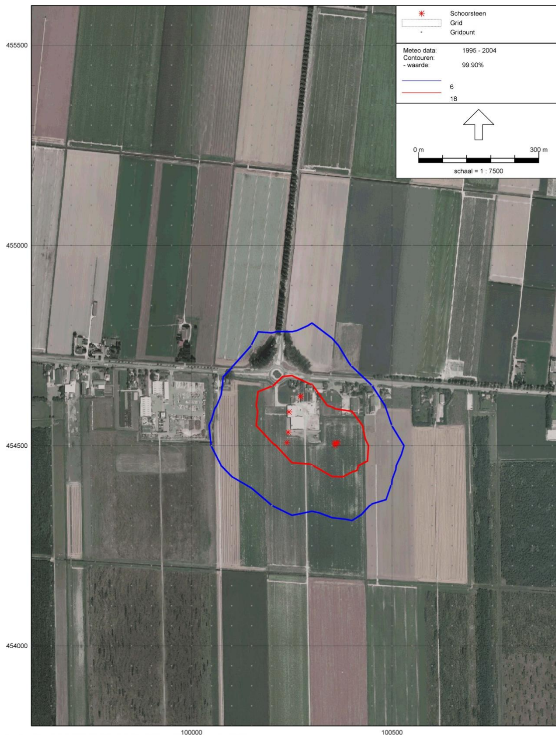
Figuur e Geurcontouren van 6 en 18 ou E /m 3 als 99,9-percentielwaarde als gevolg van Firma ████████ te Benthuizen
