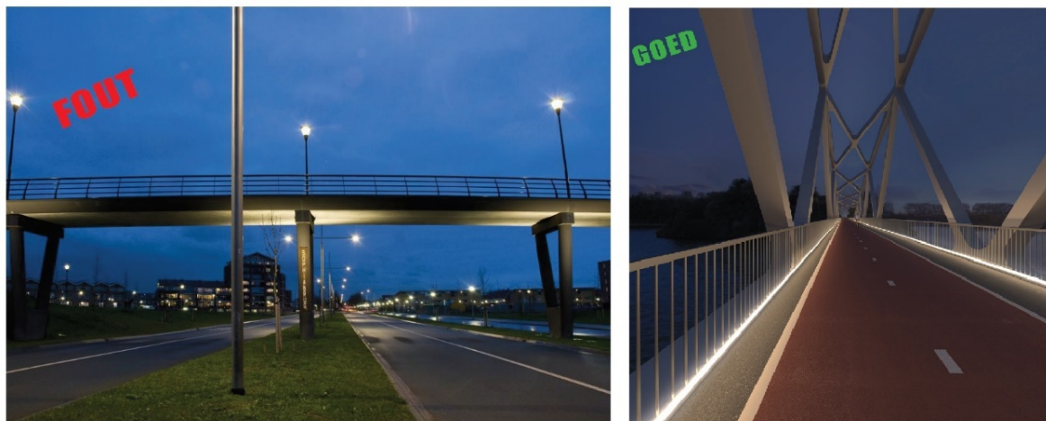
Figuur 6.3: Voorbeeld van goede en foute verlichting. Hierbij gaat het vooral om uitstralende verlichting aan de onderzijde van de brug (Beelden uit: gemeente Alphen aan den Rijn, 2019).
