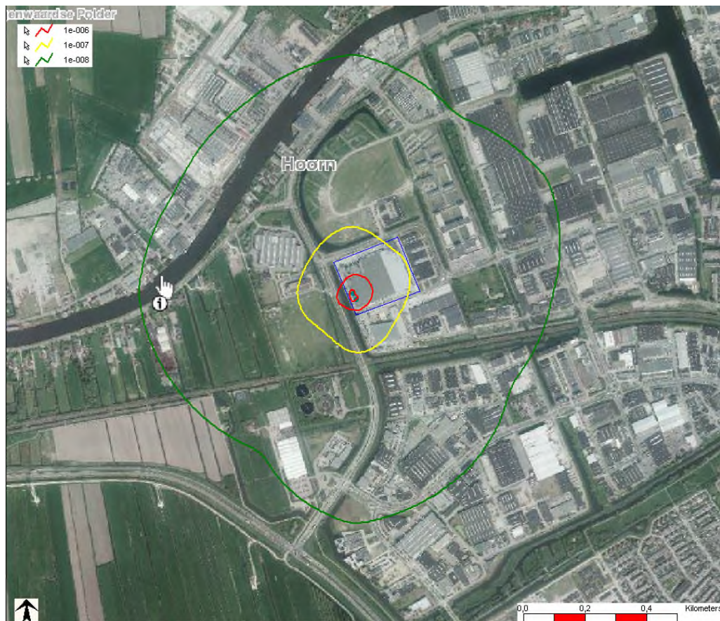
Figuur 5.1 Plaatsgebonden risico Hoogvliet DC te Alphen aan den Rijn: twee contouren 10^{-6} , en een 10^{-7} - en 10^{-8} -contour (van binnen naar buiten)
