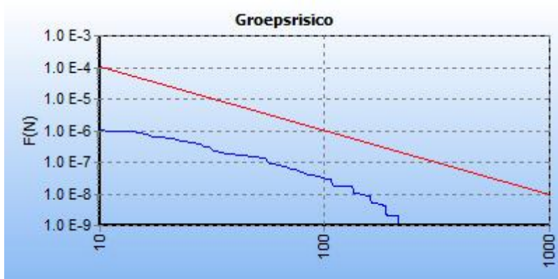
Figuur 4.9: FN curve voor W-517-02 van N.V. Nederlandse Gasunie voor de kilometer tussen stationing 1500.00 en stationing 2500.00
