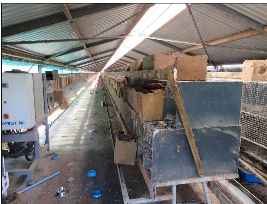
Afbeelding 6: Schuur van maximaal 3 meter hoog. De schuur is aan de zijkanten open en heeft een golfplaten dak
