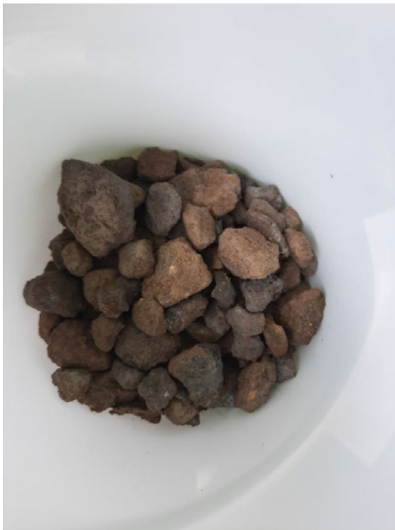
Foto 8: Emmer met de grove fractie (> 20 mm) van de puin en slakken fundering met zand ter hoogte van het pad.
