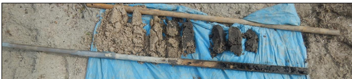
Boring 5: 0-100 cm -Mv. Gestaakt op een zeer vaste puinlaag of fundering.
