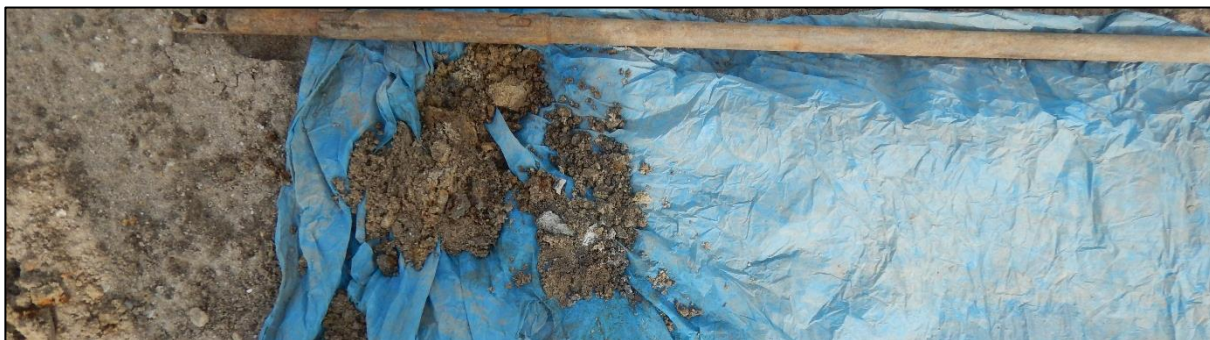
Boring 1: één van de pogingen deze boring uit te voeren. Uitgelegd materiaal is opgeboord tot een diepte van maximaal 10 cm -Mv.
