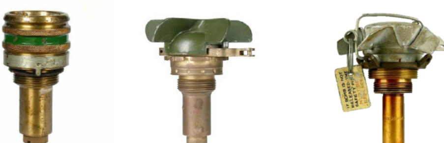
Figuur 18: Voorbeelden van drie (ongewapende) Britse bomontstekers, No. 30 (links), No. 42 (midden) en No. 44 (rechts)
