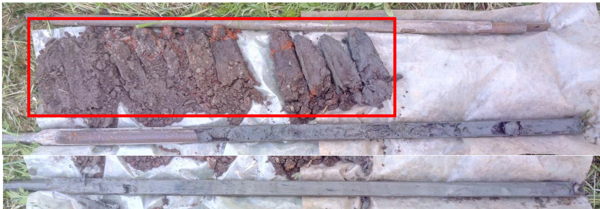
Boring 6: 0-300 cm -Mv. Het ophoogpakket is met een rood vierkant aangegeven.
