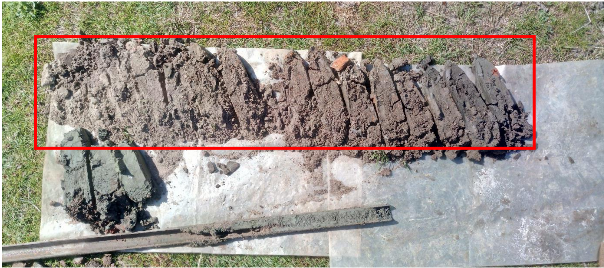
Boring 4: 0-200 cm -Mv. Het ophoogpakket is met een rood vierkant aangegeven.
