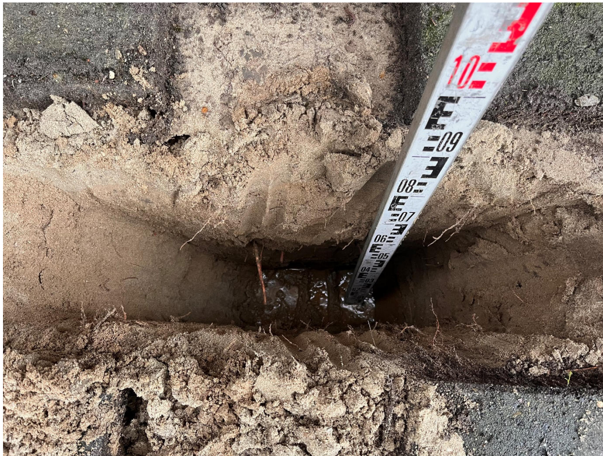
Afbeelding 4: Op 85 centimeter onder maaiveld is grondwater aangetroffen (groeiplaatsonderzoek 1)
