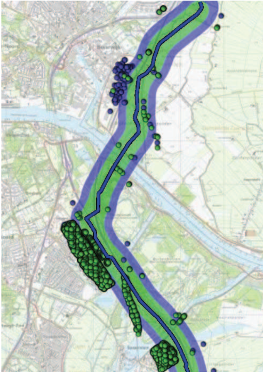
Figuur 6: Ligging van de geprojecteerde gastransportleiding A-803 segment 1 (paragraaf 2.2) stationing 0.0 – 10.7 km. Het PR is overall rond dit segment kleiner dan 10^{-6} per jaar. De blauw en groen gekleurde gebieden markeren respectievelijk de 10^{-7} en 10^{-8} per jaar PR contouren. De gekleurde punten zijn de adressen binnen het invloedsgebied van de leiding, waarbij groen staat voor bewoners en blauw voor werknemers.
