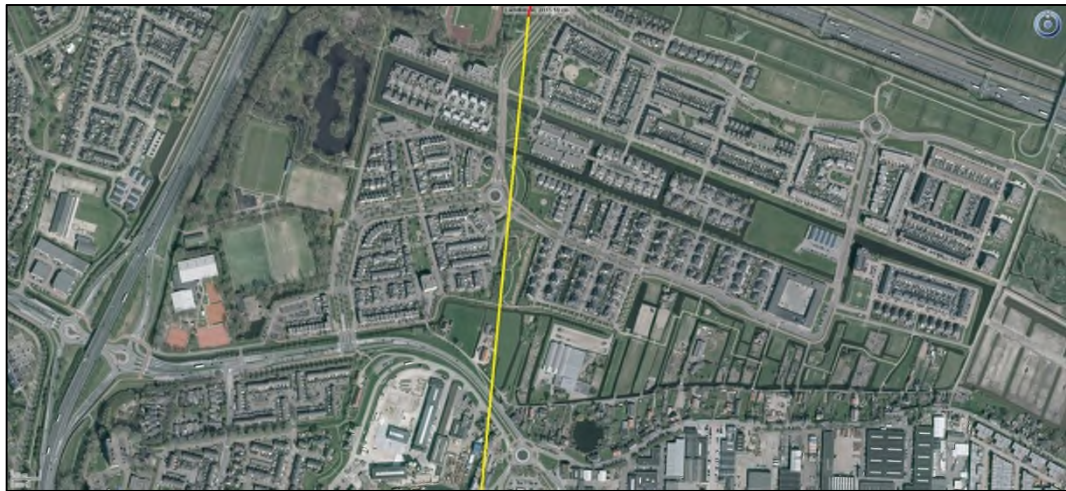
Afbeelding 3.17. Nieuw tracé 150 kV, deelgebied 3, open ontgraving (rood) en HDD (geel) aangegeven (Bron: GlobeSpotter).
