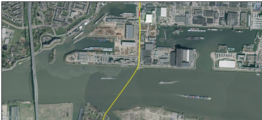
Afbeelding 3.16. Nieuw tracé 150 kV, deelgebied 2, open ontgraving (rood) en HDD (geel) aangegeven (Bron: GlobeSpotter).
