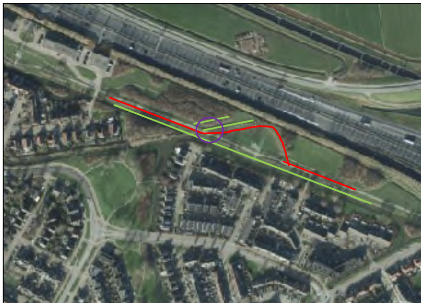
Afbeelding 6.1 Nieuw tracé 150 kV, deelgebied 4 close-up: groen: potentiële vliegroutes, rood nieuw tracé, open ontgraving, paarse cirkel geeft de locatie van de te kappen bomen weer (ondergrond GlobeSpotter).
