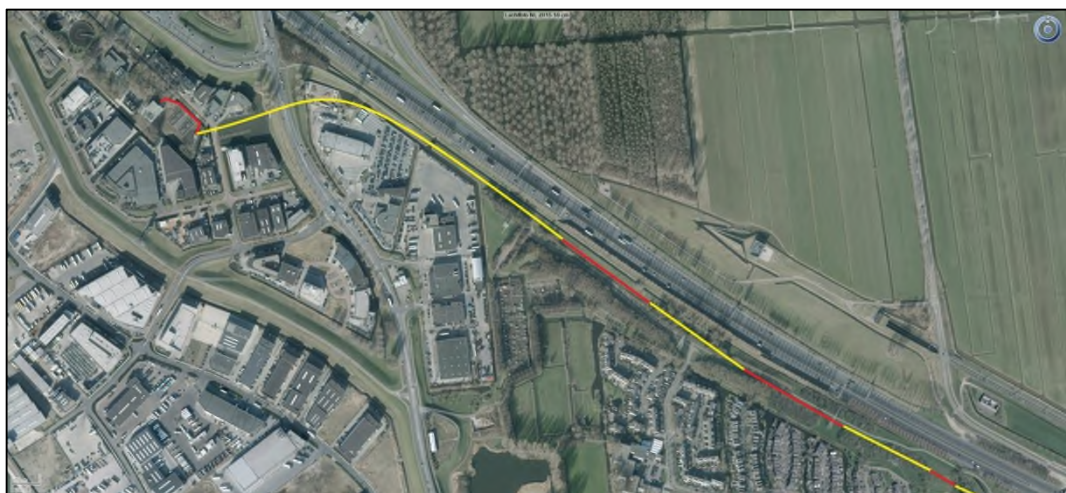
Afbeelding 3.19. Nieuw tracé 150 kV, deelgebied 5, open ontgraving (rood) en HDD (geel) aangegeven (Bron: GlobeSpotter).
