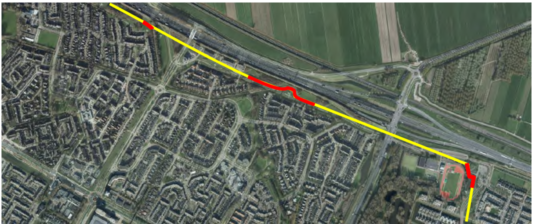
Afbeelding 3.18. Nieuw tracé 150 kV, deelgebied 4, open ontgraving (rood) en HDD (geel) aangegeven (Bron: GlobeSpotter).
