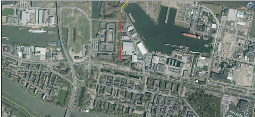
Afbeelding 3.15. Nieuw tracé 150 kV, deelgebied 1, open ontgraving (rood) en HDD (geel) aangegeven (Bron: GlobeSpotter).
