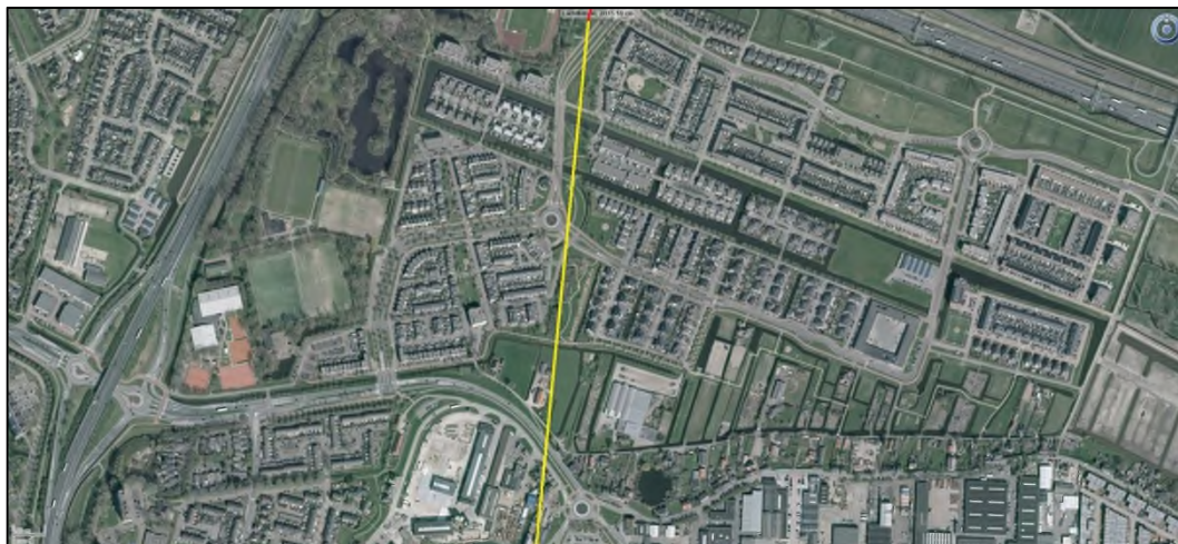
Afbeelding 3.15. Nieuw tracé 150 kV, deelgebied 3, open ontgraving (rood) en HDD (geel) aangegeven (Bron: GlobeSpotter).
