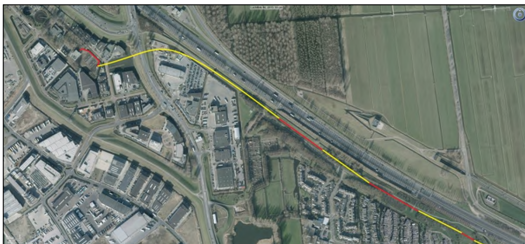
Afbeelding 3.17. Nieuw tracé 150 kV, deelgebied 5, open ontgraving (rood) en HDD (geel) aangegeven (Bron: GlobeSpotter).
