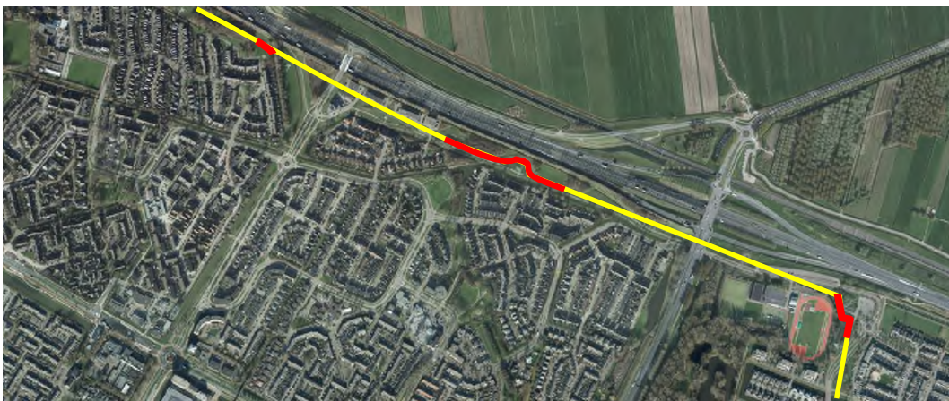
Afbeelding 3.16. Nieuw tracé 150 kV, deelgebied 4, open ontgraving (rood) en HDD (geel) aangegeven (Bron: GlobeSpotter).
