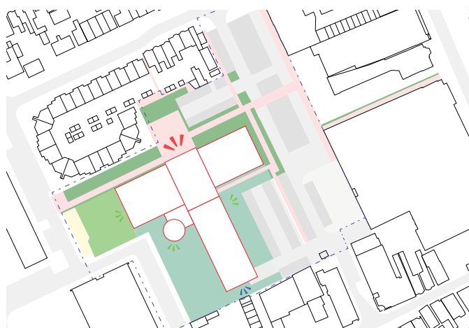
Een samengesteld gebouw met één hoofdentree
