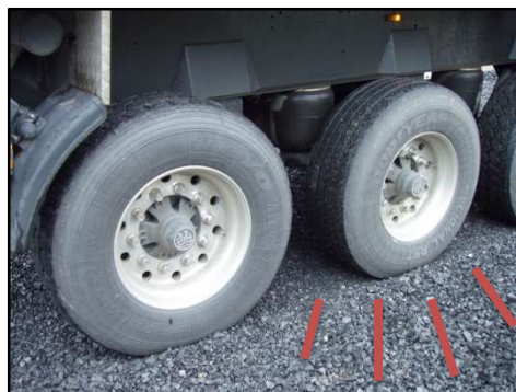
Figuur 2: hoek van inwendige wrijving > 55° levert brede spreiding van krachten naar de ondergrond.
