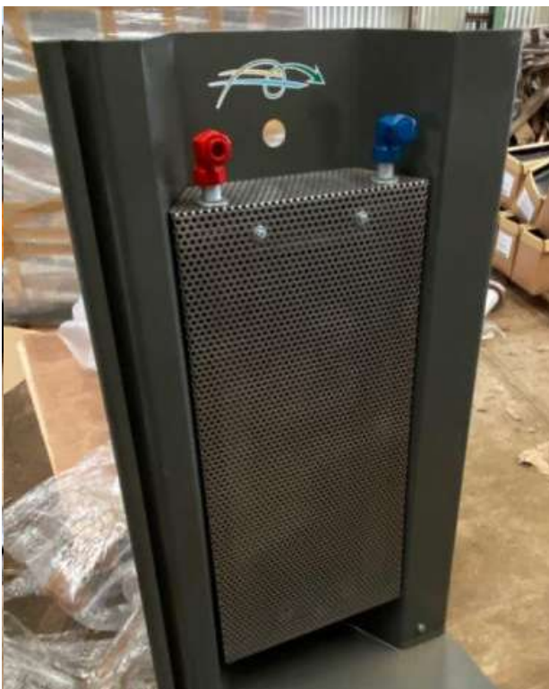
Aansluiting voor leidingenwerk
