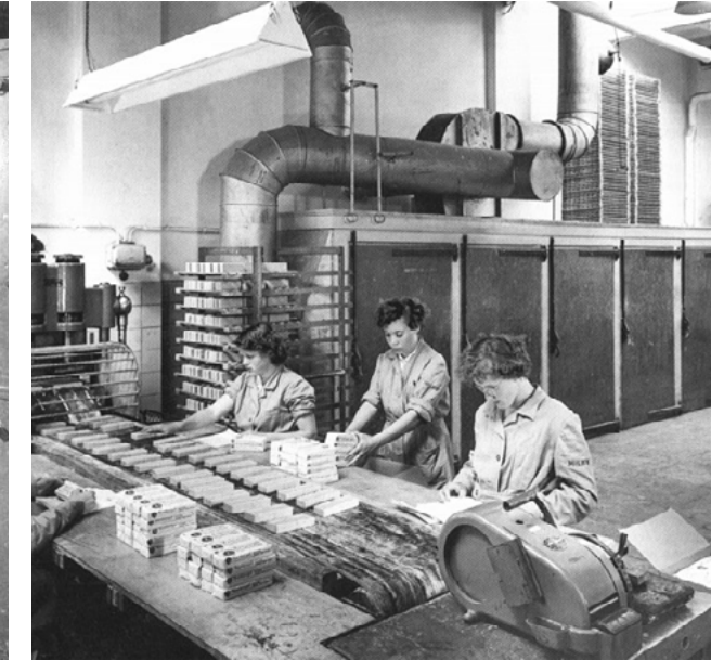
V.l.n.r.: de koelpers, de droogkasten en de automatische verpakkingsmachine van de HILKO - zeepfabriek, ca. 1950. [Website Zaanse Industrieel Erfgoed].
