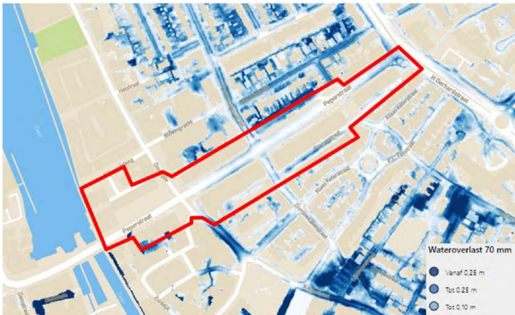
Figuur 3 - effecten van een bui van 70mm per uur in de huidige situatie (bron: klimaatatlas https://hnhk.klimaatmonitor.net/ )
