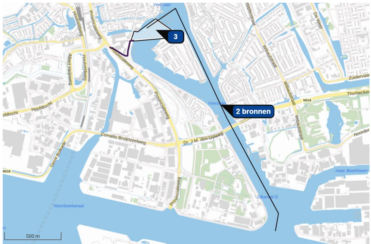
Figuur 3.2 gemodelleerde bronnen realisatiefase (de vlakbron is voor mobiele werktuigen en de lijnbronnen zijn voor het bijbehorende verkeer). Bron: AERIUS, 2023.
