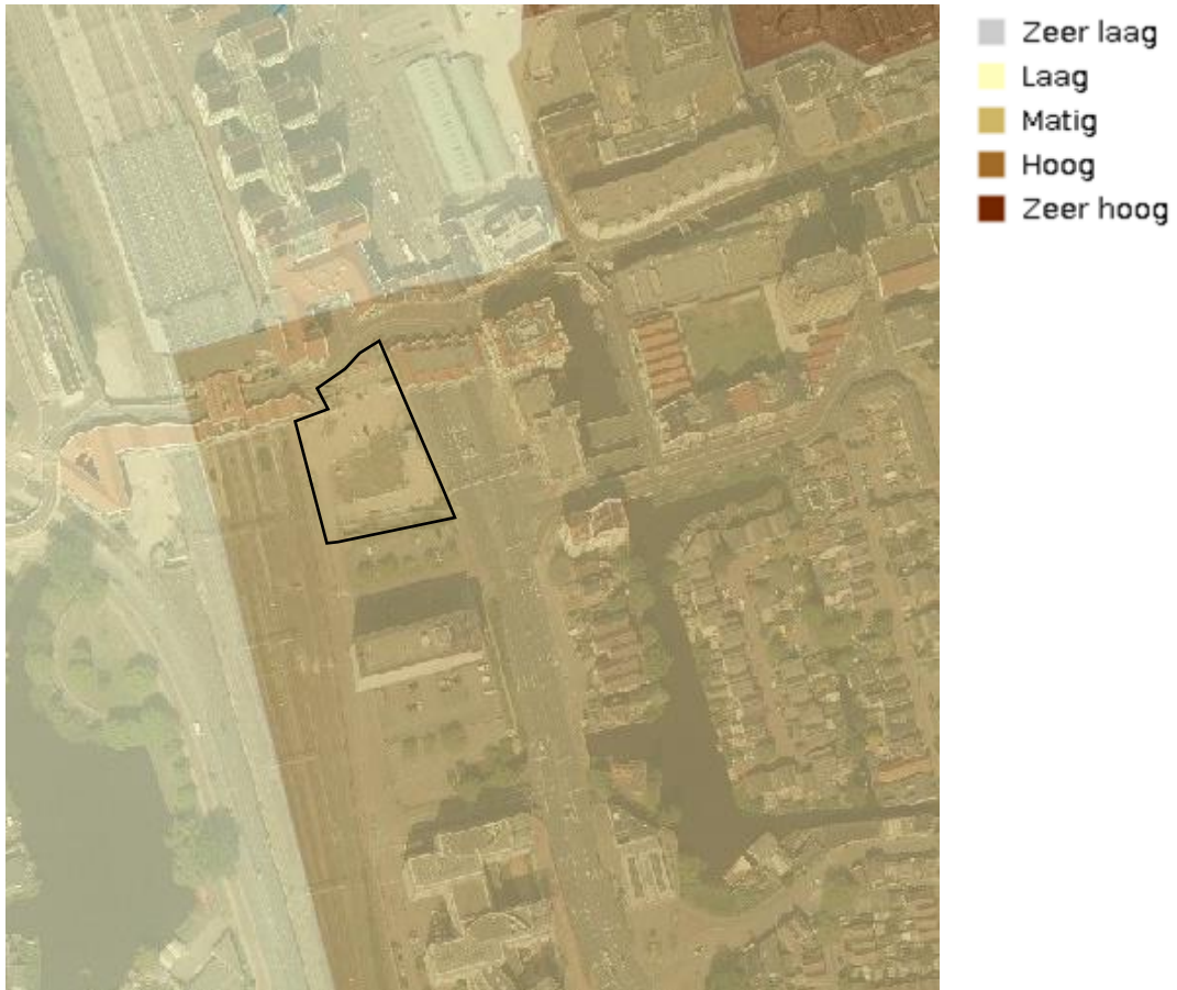
Figuur 2-3: risico op paalrot als gevolg van droogte.
