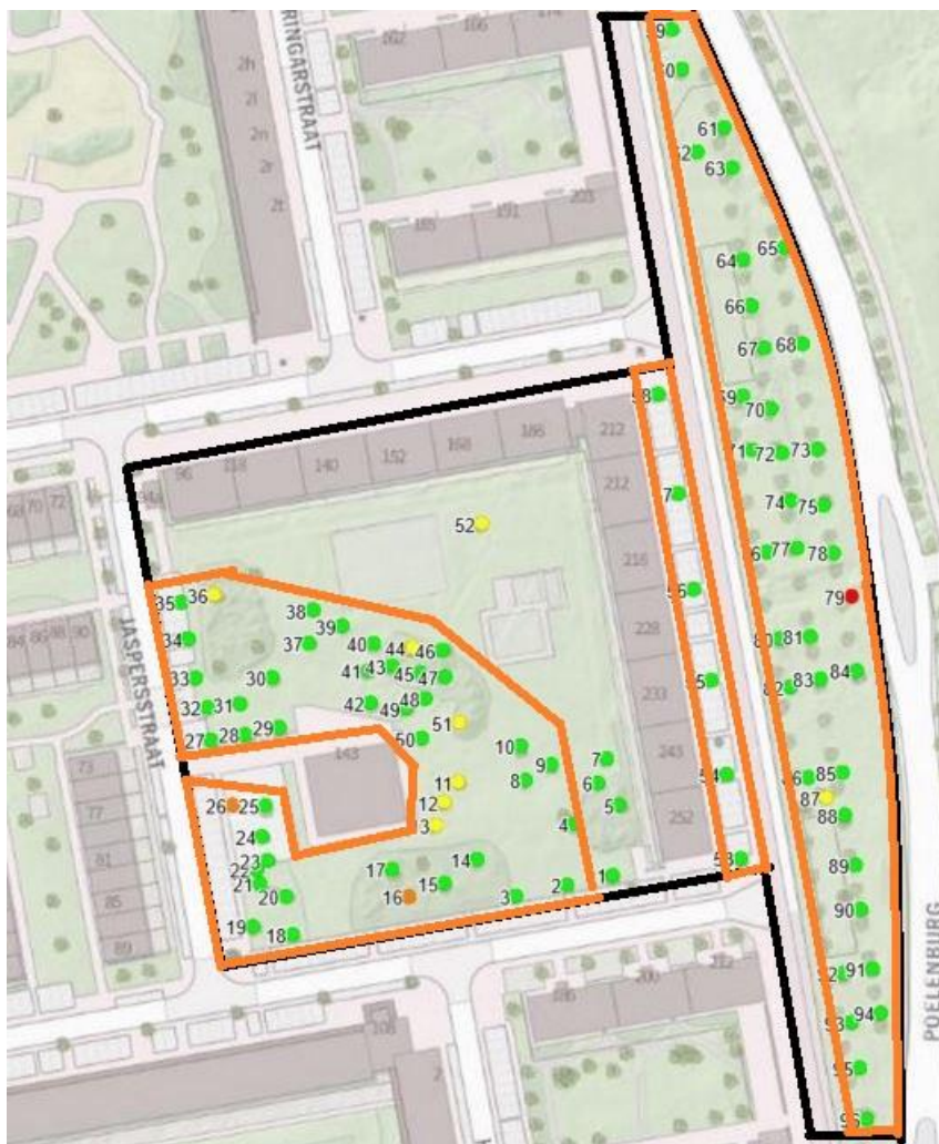
afb. 4: overzicht beschermd boomgebied aanbrengen. de oranje lijn is de plaats waar boombescherming moet komen
