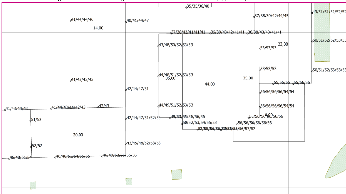
Figuur 5.5: berekende geluidbelasting vanwege railverkeerslawaai (Zaandam-Hoorn) op de rekenpunten/waarneemhoogte waar de voorkeursgrenswaarde wordt overschreden ( L_{den} in dB)
