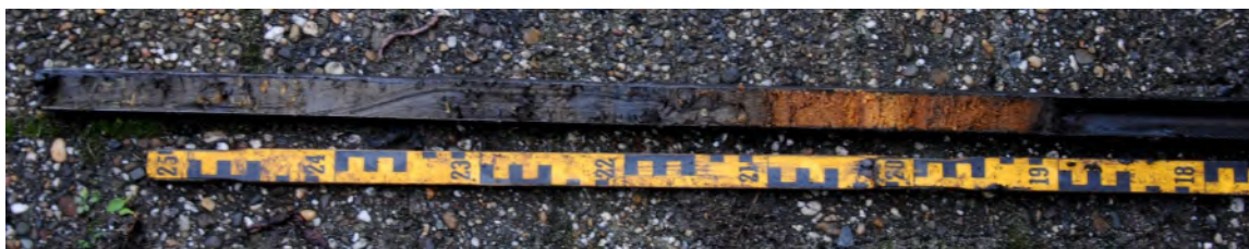
Afbeelding 8. Detailfoto van de laag zaagsel in boring 12.
