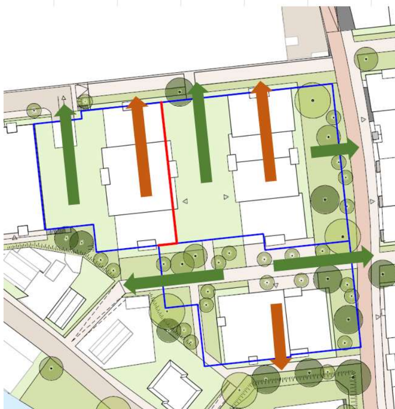
Figuur 2 Voorstel afvoer regenwater blok 3 en 5
