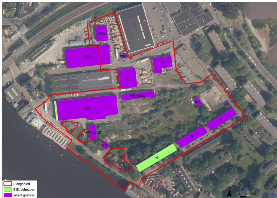
Figuur 2.3 De te slopen gebouwen in het plangebied
