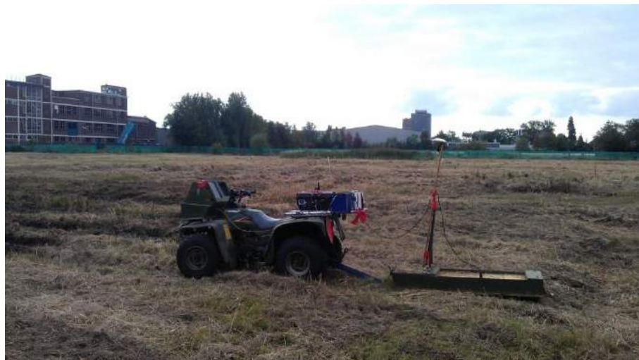
Figuur 9: quad met daaraan gemonteerd de gammaspectrometer (achter op de bagagedrager van de quad) en de grondradar (antenne achter de quad).
