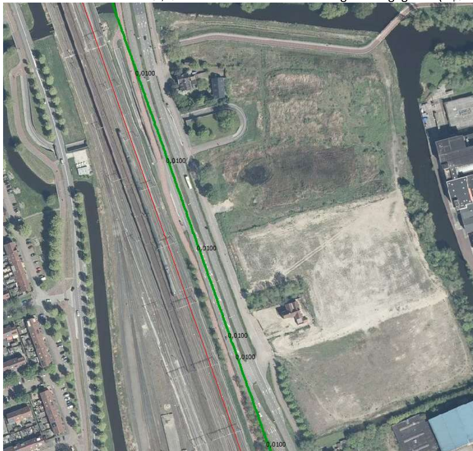
Afbeelding 3: indicatief berekende trillingscontouren V_{\text{per}}
