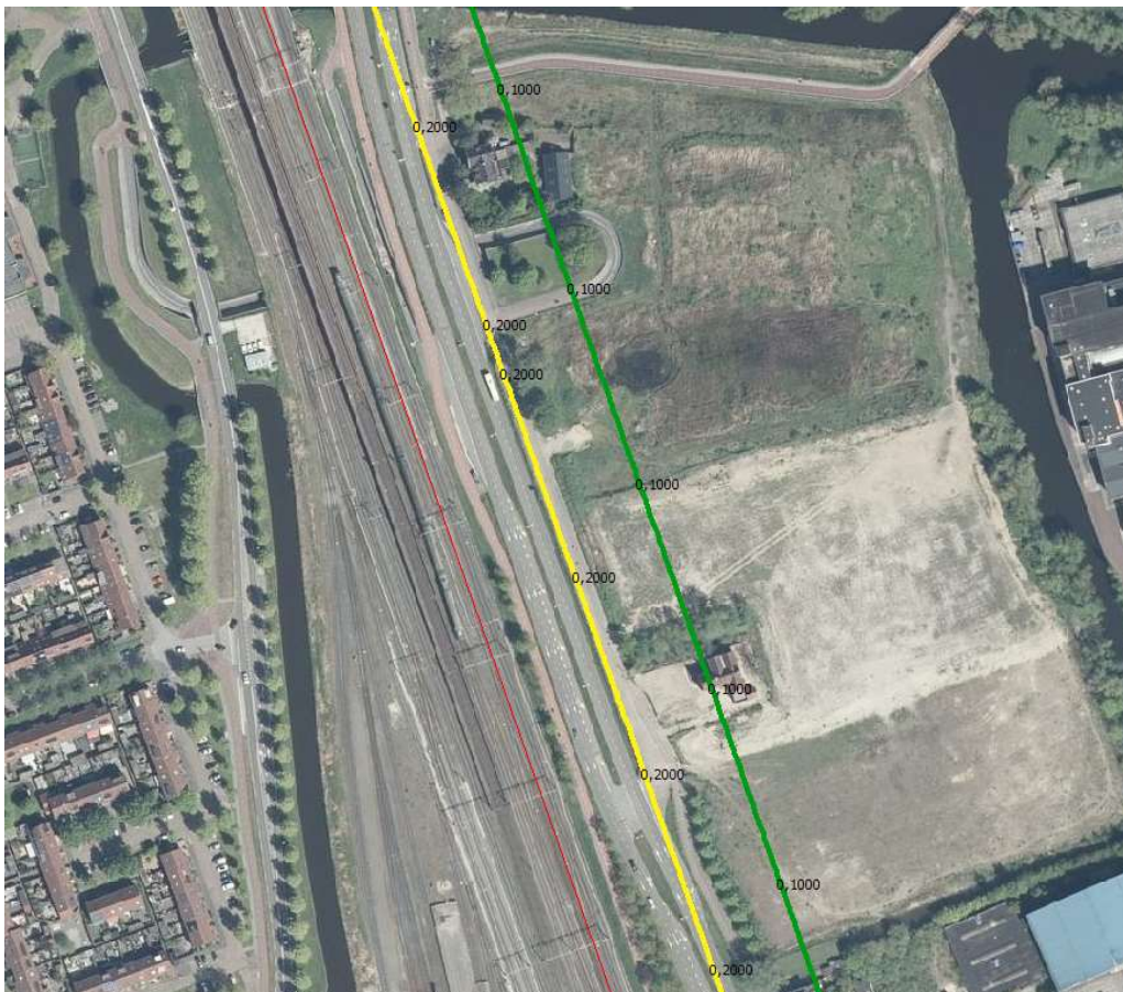
Afbeelding 2: indicatief berekende trillingscontouren V_{\text{eff, max}}
