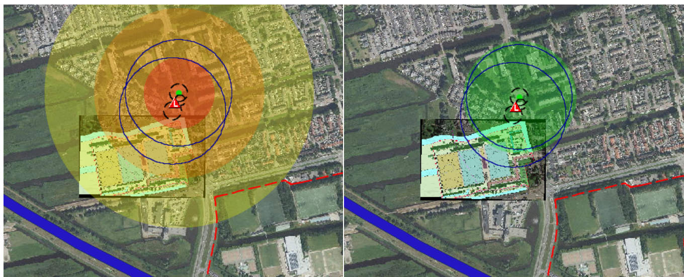
Figuur 2: overzicht LPG-tankstation, effectafstanden warme BLEVE links gebaseerd op scenarioboek 2 , rechts gebaseerd op Circulaire LPG-effectafstanden zeer kwetsbare objecten 3
